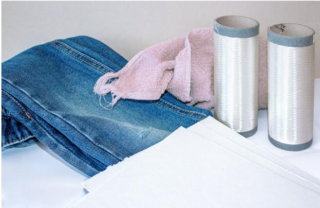
**Abb. 1** Das aufgespulte Viskose-Filamentgarn wurde aus recycelter Baumwolle gefertigt, die in Form von Zellstoffplatten vorliegt. Forscherinnen und Forscher am Fraunhofer IAP haben einen Weg gefunden, aus Baumwollkleidung wie Jeans hochwertige neue Kleidungsstücke herzustellen, anstatt wie bisher nur Putzlappen.
